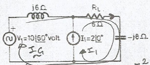
$$-V_1 + (j6) \cdot I_G + 6 \cdot (I_1 + I_G) - (j8) \cdot (I_1 + I_G) = 0$$
