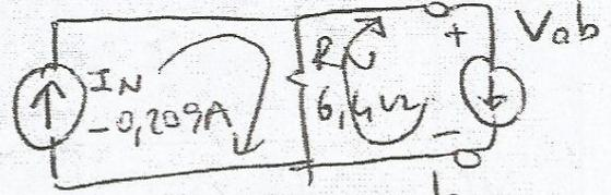
$$V_{RN} = V_{ab} = 6,4 \cdot (-0,209) = -1,3376 \text{ V}$$
