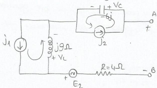
Bobin ve kondansatör üzerindeki gerilimleri bulabiliriz.
